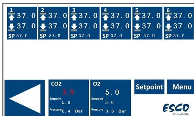
**Figura 14.5** Vista de la alarma de concentración de CO<sub>2</sub> baja en la pantalla principal de la incubadora multicámara FIV MIRI® TL6
