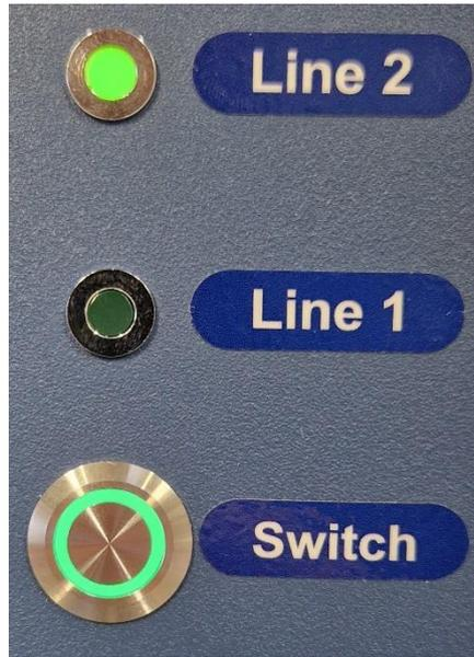
**Figura 20.4** El interruptor que cambia la línea de la incubadora multicámara FIV MIRI® TL12 y la Línea 1 activa
