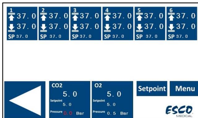
**Figura 14.7** Vista de la alarma de presión de gas CO<sub>2</sub> en la pantalla principal de la incubadora multicámara FIV MIRI® TL6
