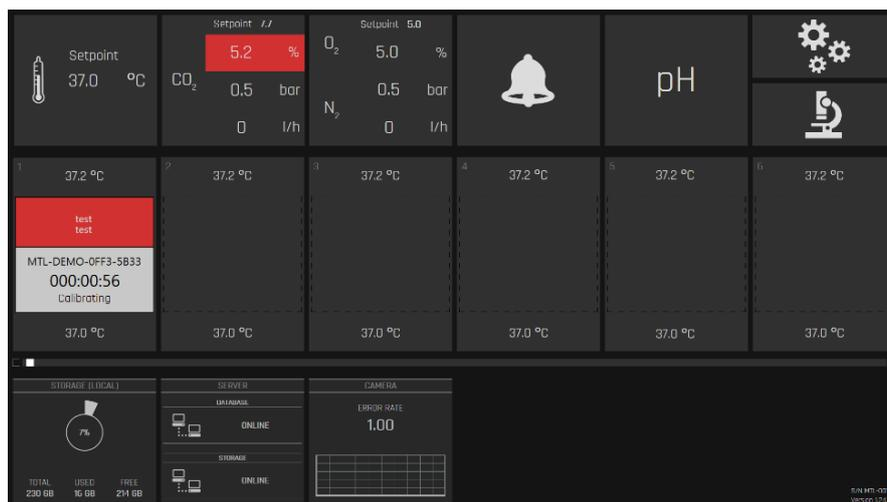
**Figura 20.45** Vista de la alarma de concentración de CO<sub>2</sub>
