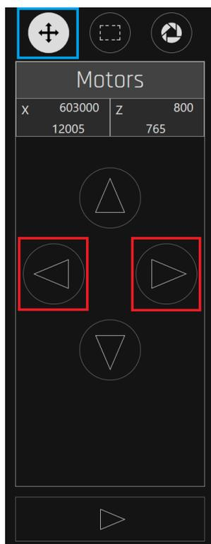
**Figura 20.35** Dispositivo para ajustar la posición del pocillo en el eje X
