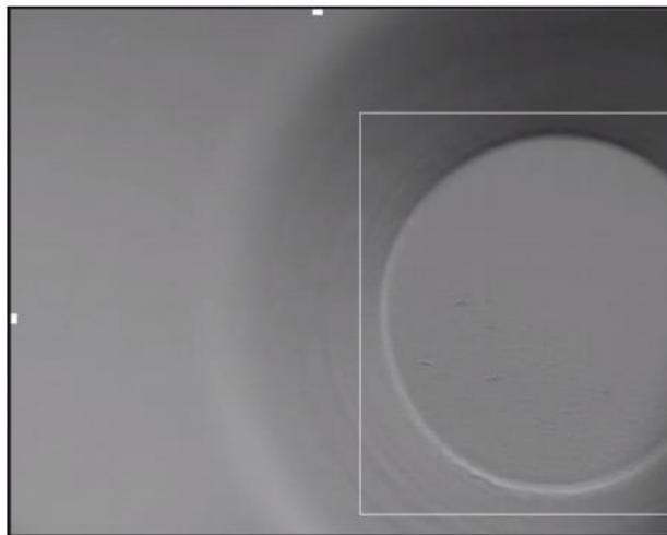
**Figura 20.34** Ejemplo de un pocillo colocado incorrectamente en la pantalla de la vista de cámara.
