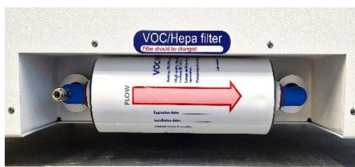
Figura 12.3 Filtro COV/HEPA correctamente instalado
