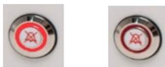
**Figura 14.11** Botón de alarma que indica el estado de alarma
