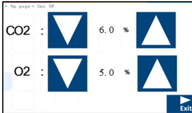
**Figura 13.16** Vista del valor programado del gas de la incubadora multicámara FIV MIRI® TL6
