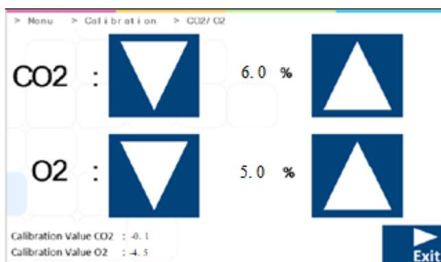
**Figura 13.24** Vista de calibración de CO<sub>2</sub>/O<sub>2</sub> de las incubadoras multicámara FIV MIRI® TL6 y MIRI® TL12
