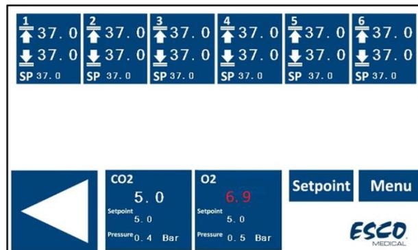
**Figura 14.6** Vista de concentración de O<sub>2</sub> alta en la pantalla principal de la incubadora multicámara FIV MIRI® TL6
