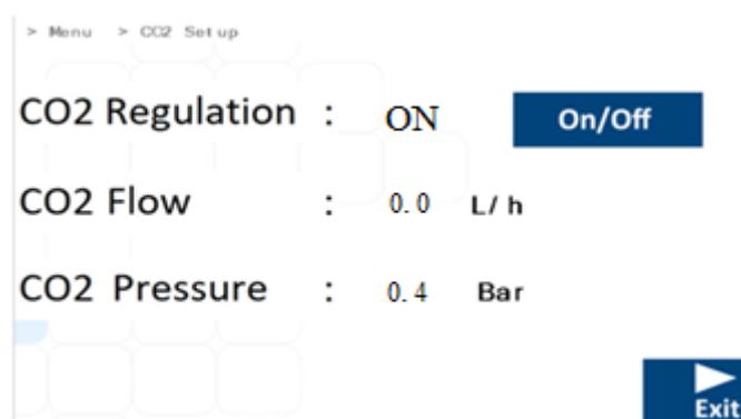
Figura 16.2 Vista del Submenú de CO<sub>2</sub> en la incubadora multicámara FIV MIRI® TL6 y MIRI® TL12
