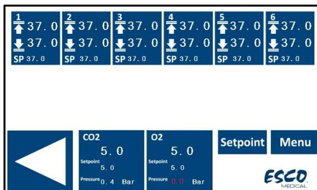
**Figura 14.8** Vista de la alarma de presión de gas N<sub>2</sub> en la pantalla principal de la incubadora multicámara FIV MIRI® TL6
