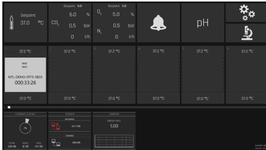
**Figura 20.44** Vista de alarma de servidor desconectado
